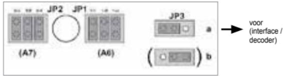
JP1 - brug geplaatst: 1-1 - Grootlicht, schakelbaar via AUX6
