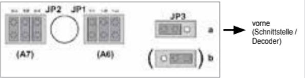
JP1 - Brücke gesetzt: 1-1 - Fernlicht, schaltbar über AUX6
